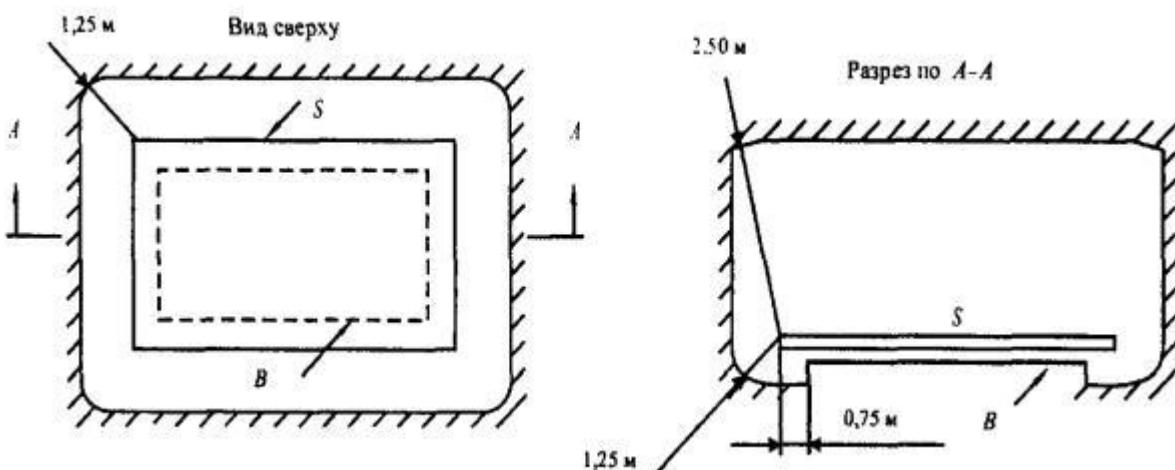
**Рис. 1.7.6.** Зона досягаемости в электроустановках до 1 кВ:
