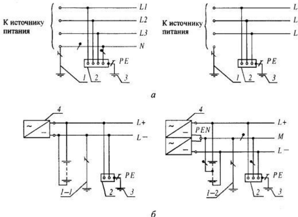
**Рис. 1.7.5.** Система ТТ переменного (а) и постоянного (б) тока. Открытые проводящие части электроустановки заземлены при помощи заземления, электрически независимого от заземлителя нейтрали:
